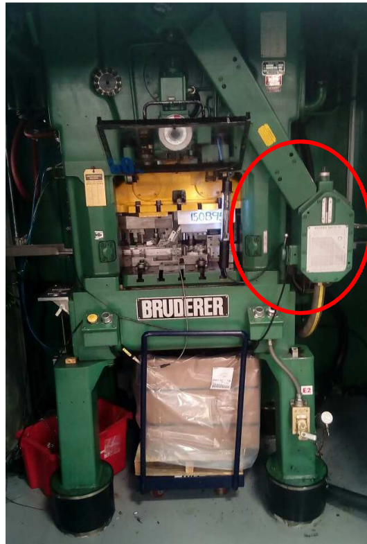
Figura 24: Vista frontal de la prensa estampadora; dentro del círculo rojo se puede ver parte del alimentador.
