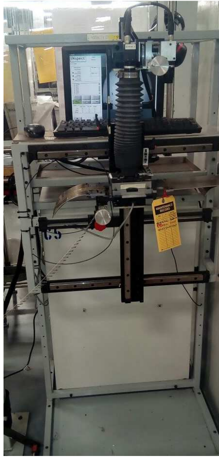
Figura 29: Sistema de visión ubicado a la salida del material de la prensa.
