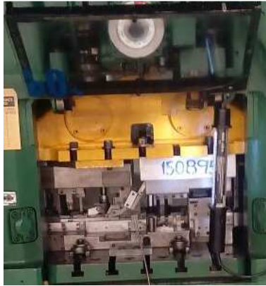
Figura 26: Vista frontal de un troquel en reparación menor dentro de la prensa.
