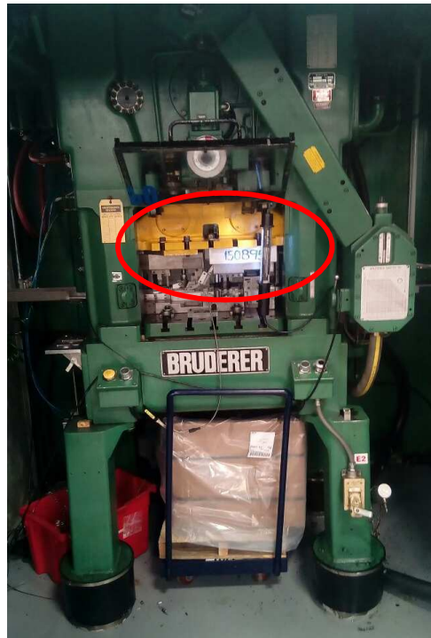
Figura 36: Parte de la prensa donde se muestra el RAM, que, para indicar la posición inicial de los imanes, deberá estar en su punto más alto.
