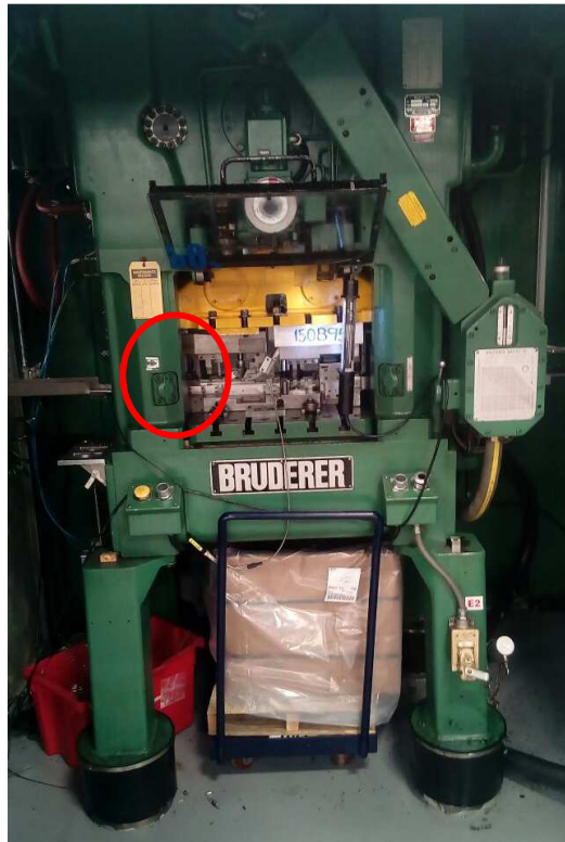
Figura 28: Ubicación del sensor dentro del troquel.
