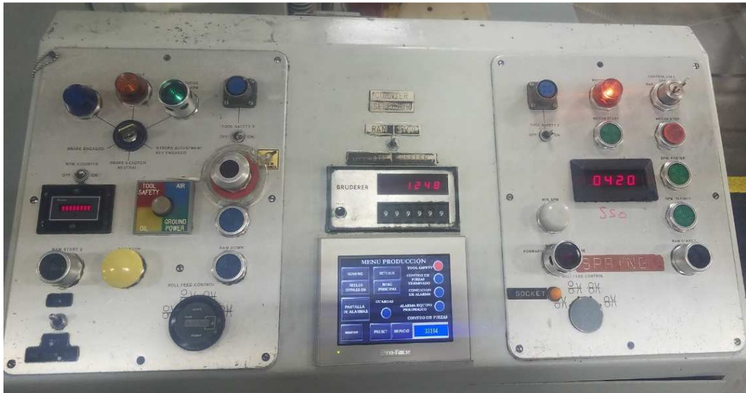
Figura 34: Panel de control antes de la mejora; varía la cantidad de botones de prensa en prensa.
